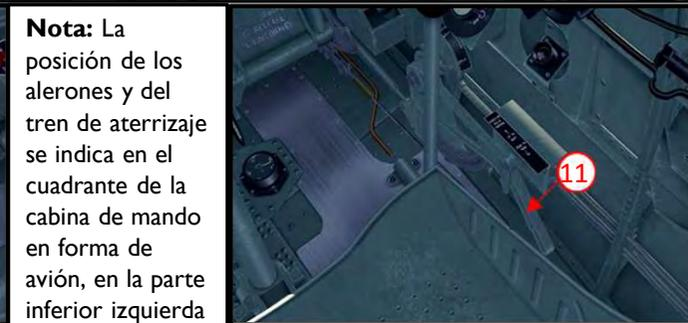
Palanca del radiador - pared de la cabina (derecha)
